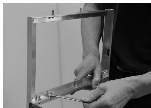
Installation du bâti de la console
