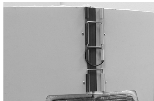
Aislamiento del acumulador en el centro de la brida
